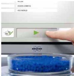
**3** 轻触屏幕的触发按钮，即开始进行测量。
